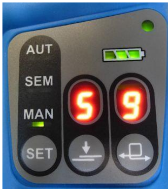
Batterie Li-Po pleine
